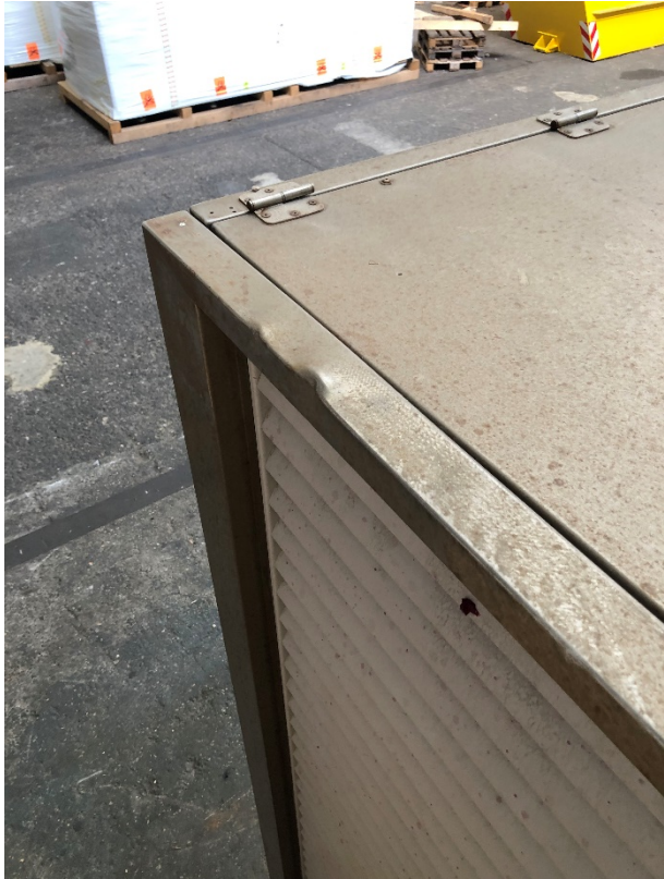
Ansicht: Schaden Ansaugung oben links
